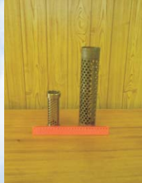
Пробивка отверстий диаметром 6 мм и 8 мм в трубчатых фильтрах из нержавеющей стали
