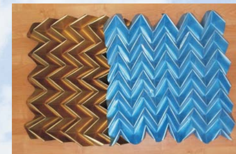
Z-гофр - наполнитель акустической панели
