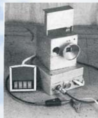
Многопараметрический детектор утечки воздуха из международной космической станции (МКС)
