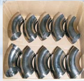
Промышленная партия тонкостенных крутоизогнутых отводов из стали 12X18N10T
