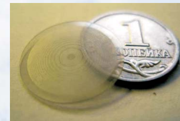
Алмазная дифракционная линза, предназначенная для фокусировки излучения CO 2 -лазера
