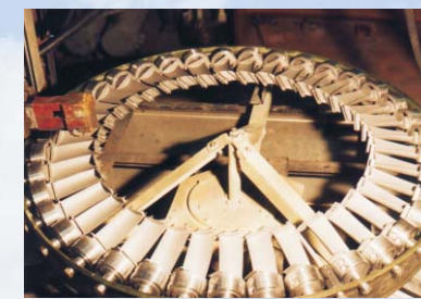
Нанесение турбинных лопаток в колесе на специальном оборудовании
