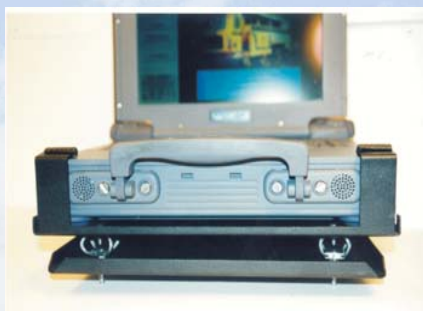
Система виброзащиты бортового компьютера в путевых машинах (НТЦ «Путеец», г. Новосибирск)
