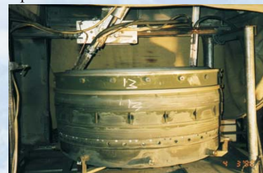
Нанесение камеры сгорания GT-10 (Сименс) на специальном оборудовании, созданном в институте
