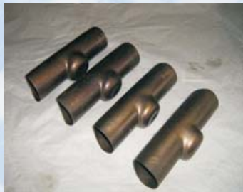
Тонкостенные тройники из титанового сплава ПТ7М
