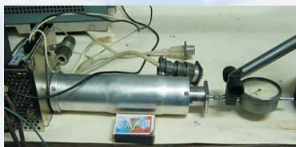
Опытный образец силового привода из сплава с эффектом памяти формы для узла расчеховки космического аппарата
