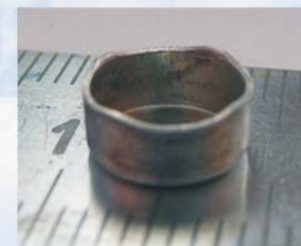
Реальная деформированная геометрия полый детали
