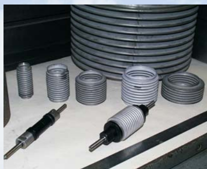
Сильфоны, калиброванные давлением импульсного магнитного поля
