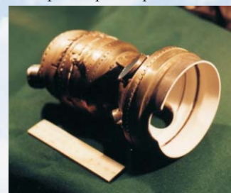
Труба жаровая двигателя НК-36СТ с теплозащитным металлокерамическим покрытием
