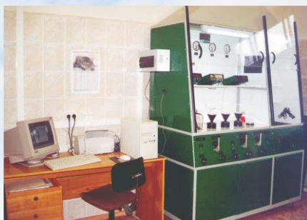
Пост цехового контроля КВАНТ-903
