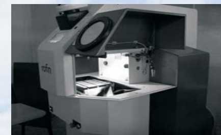
Установка ROFIN StarWeld, оснащенная Nd:ИАГ-лазером с длиной волны излучения 1,06 мкм
