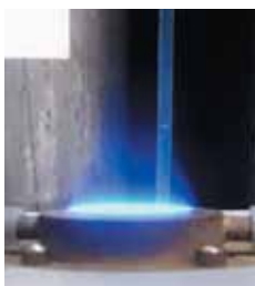
Эта горелка обладает системой охлаждения, что позволяет получить идеальные условия для изучения процессов горения
