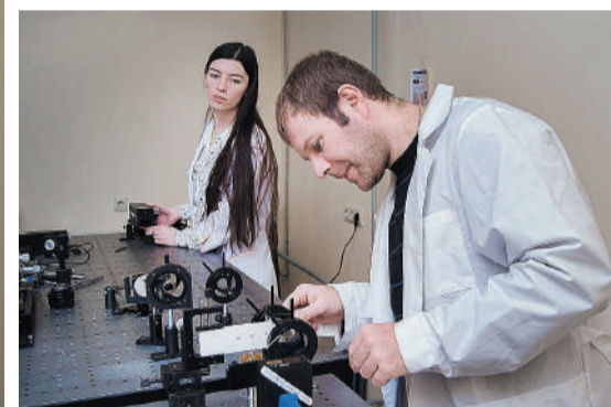
Диагностика линзы гиперспектрометра
