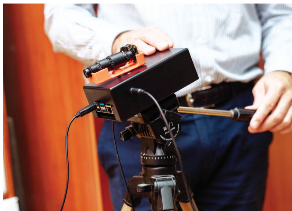
Компактный гиперспектрометр (на фото размещён на оранжевой подложке), оборудованный уникальными дифракционными линзами, устанавливается на беспилотник и сканирует поле на предмет зарослей сорных растений или повреждённых насекомыми посевов
