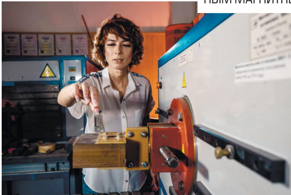
Ирина Беляева помещает пробирку с образцом заражённого ростка картофеля в установку. Следующий этап – облучение импульсным магнитным полем
