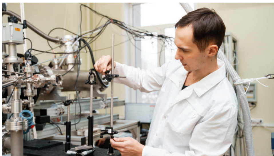
Внутри установки «Криогенные поверхностные процессы» учёные воспроизводят условия различных уголков межзвёздной среды. На фото сотрудник кафедры физики и СО ФИАН Алексей Торбин настраивает ячейки генерации вакуумного ультрафиолета
