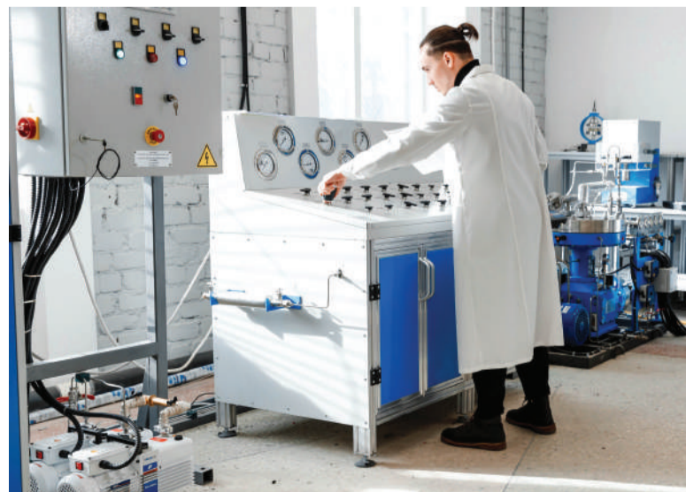
В лаборатории криогенной техники Владислав Боровик настраивает давление на редукторе для отбора пробы ксенона из шар-баллона после заправки
