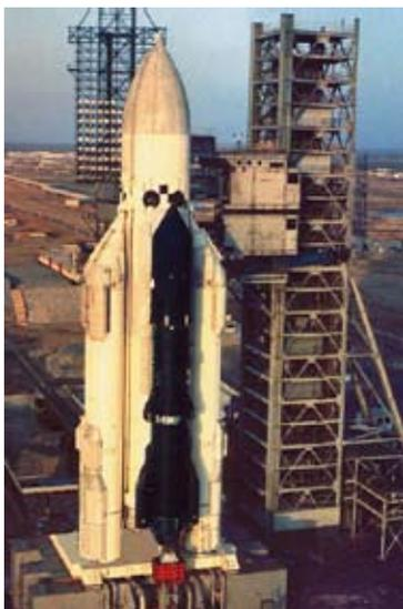
ведение 4-х боковых блоков первой ступени, вторая ступень с орбитальным кораблем продолжала полет по заданной программе. На 480 секунде от второй ступени отделился орбитальный корабль и продолжил самостоятельный полет по заданной траектории, облетев почти два круга вокруг земного шара, в автоматическом режиме в условиях штормового предупреждения метеорологов произвел приземление на взлетно-посадочную полосу космодрома Байконур в 9 часов 25 мин.
