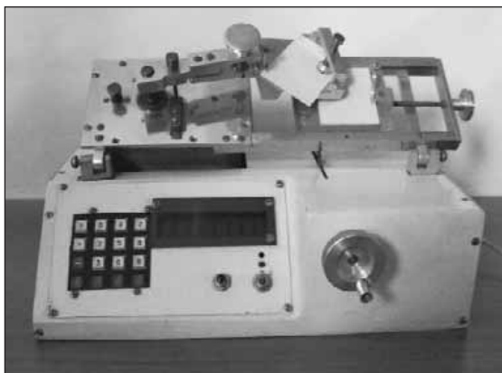
Прибор экспресс - контроля чистоты поверхности подложки: диапазон измеряемой степени чистоты - 10-6 - 10-9 г/см 2 . Создан с участием студентов
