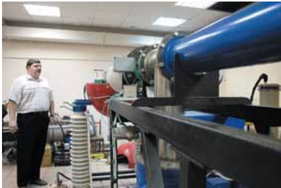
► Алексей Пияков демонстрирует стенд моделирования факторов космической среды (ускоритель частиц)
