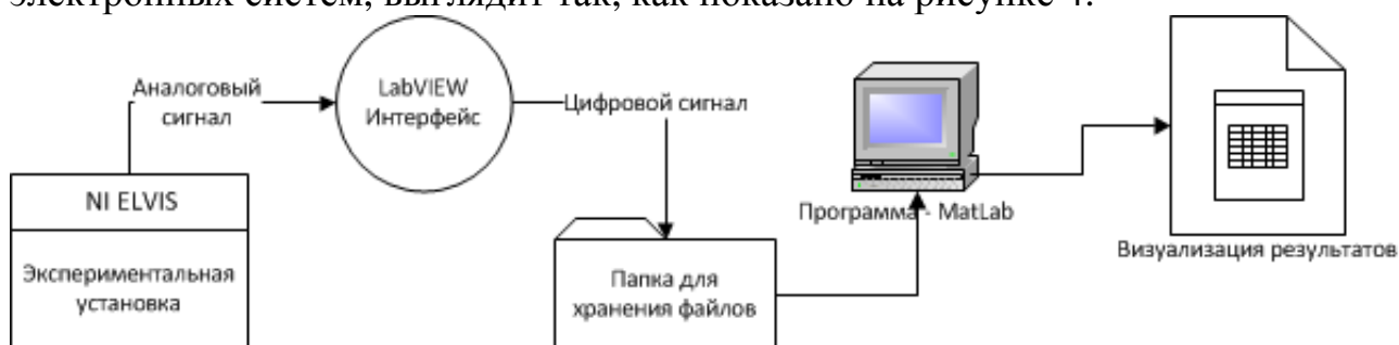
Рис. 4. Концептуальная схема логики работы ядра модуля, предназначенного для обработки экспериментальных данных
