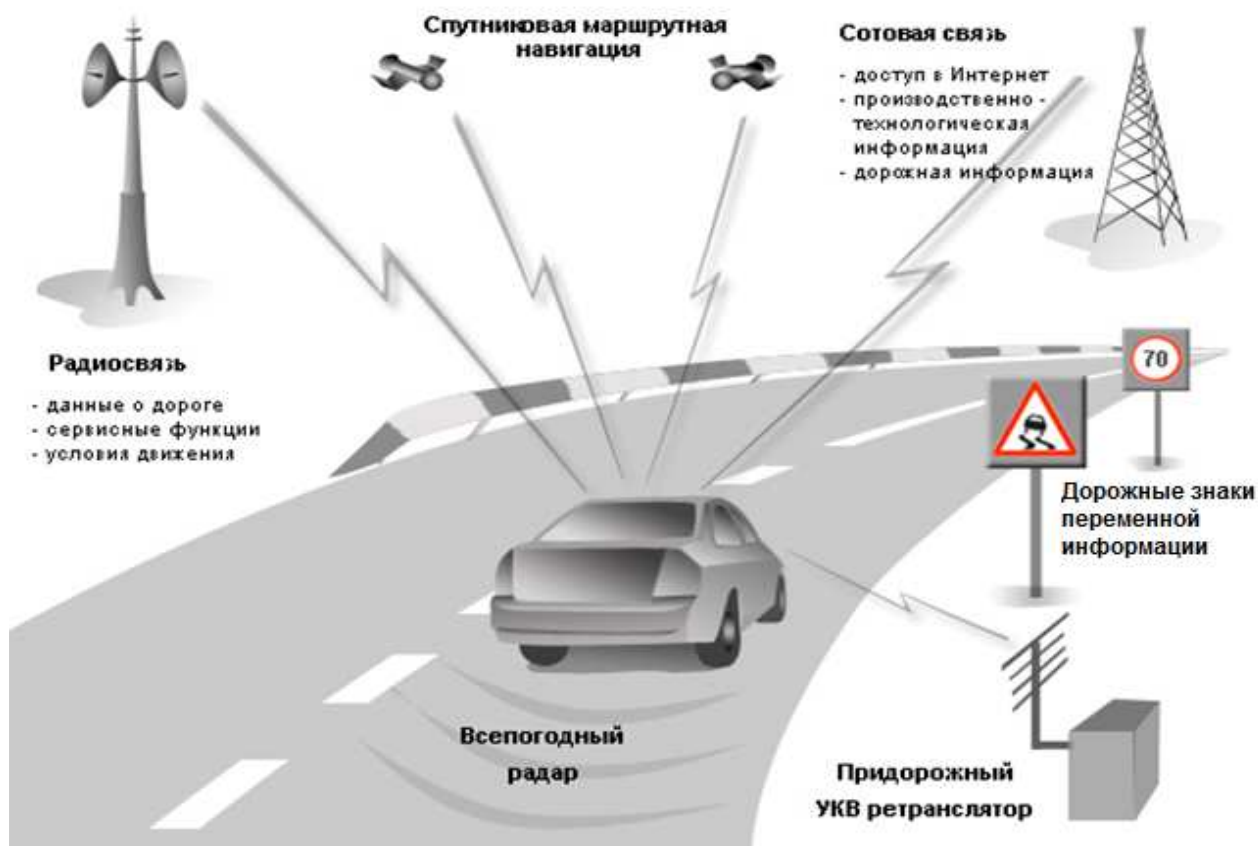
Рис. 1. Структурная схема обмена информацией V2I
