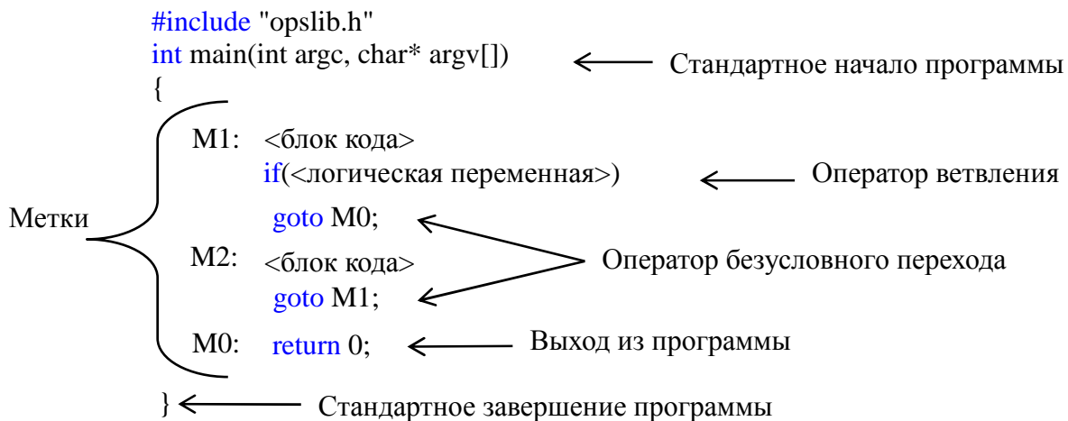
Рис. 3. Логическая схема входа
