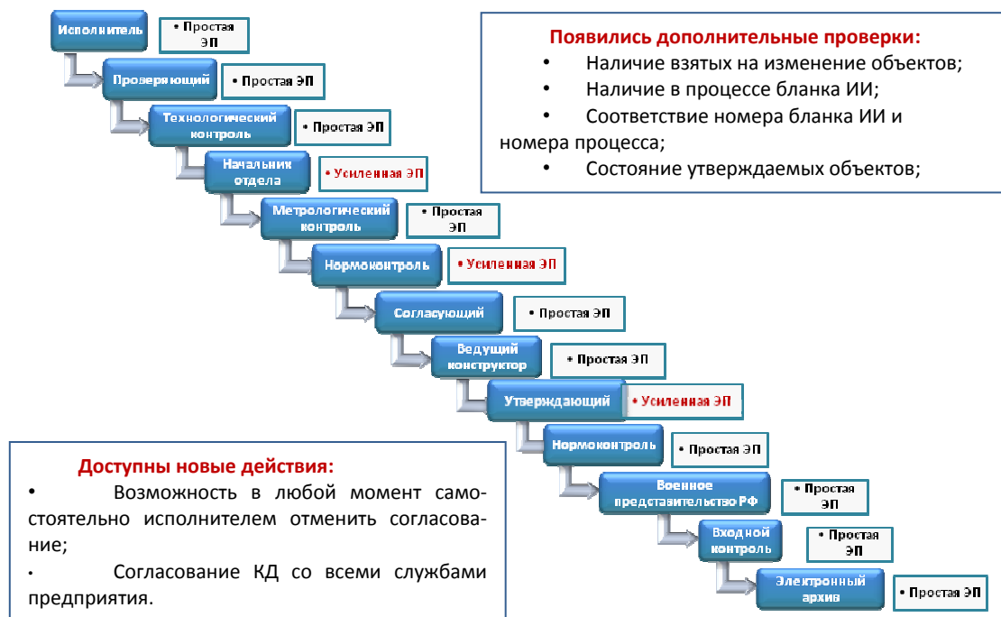
Рис. 4. Принципиальная схема процесса согласования КД с ЭП
