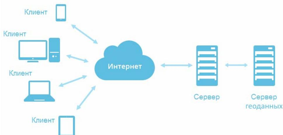
Рис. 1. Архитектура веб-ГИС
