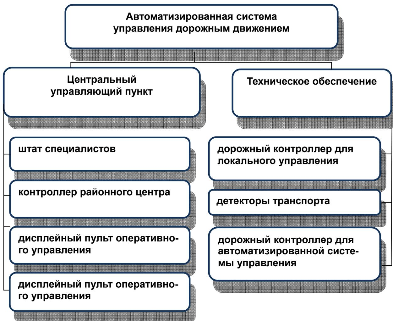
Рис. 1. Архитектура автоматизированной системы управления дорожным движением
