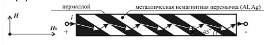
Рис. 1. Структура типа «barber-pole» единичного  $AMR$ -элемента
