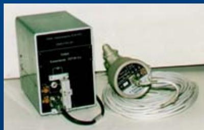
Взрывозащищенный фотоэлектрический датчик контроля чистоты жидкостных систем ПОТОК-ЕХ
