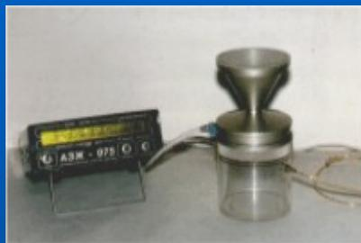
Анализатор загрязнения жидкости методом отобранных проб АЗЖ-975. Номер в госреестре 29856-0
