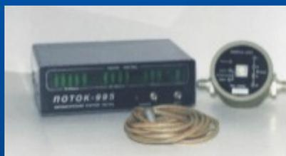
Индикатор загрязнения жидкости методом встроенного контроля ПОТОК-995
