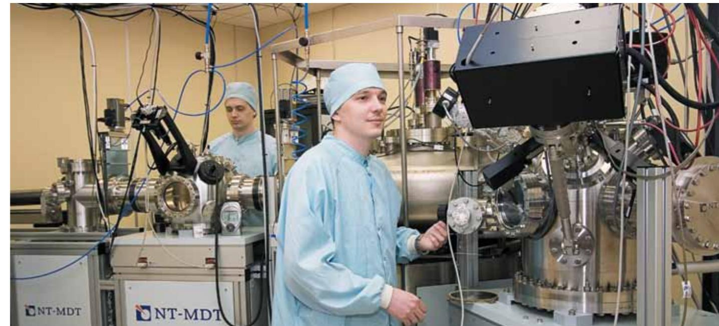
Научно-образовательный центр нанотехнологий оснащен сверхвысоковакуумным комплексом НАНОФАБ-100
