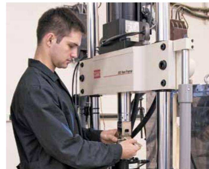
НИИ авиационных конструкций: исследование композитных материалов на сервогидравлической испытательной установке
