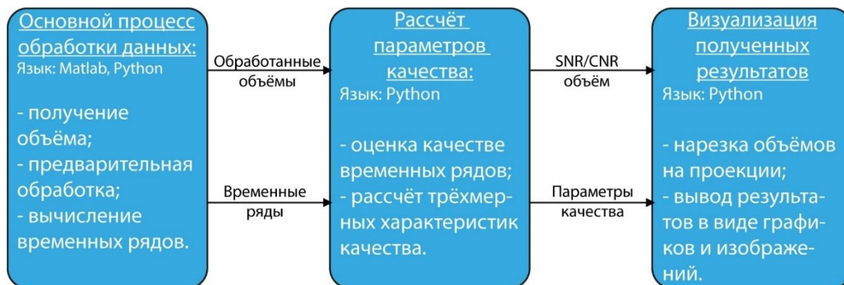
Рисунок 15 – Пример интеграции модуля контроля качества в общий рабочий процесс программного комплекса OpenNFT.
