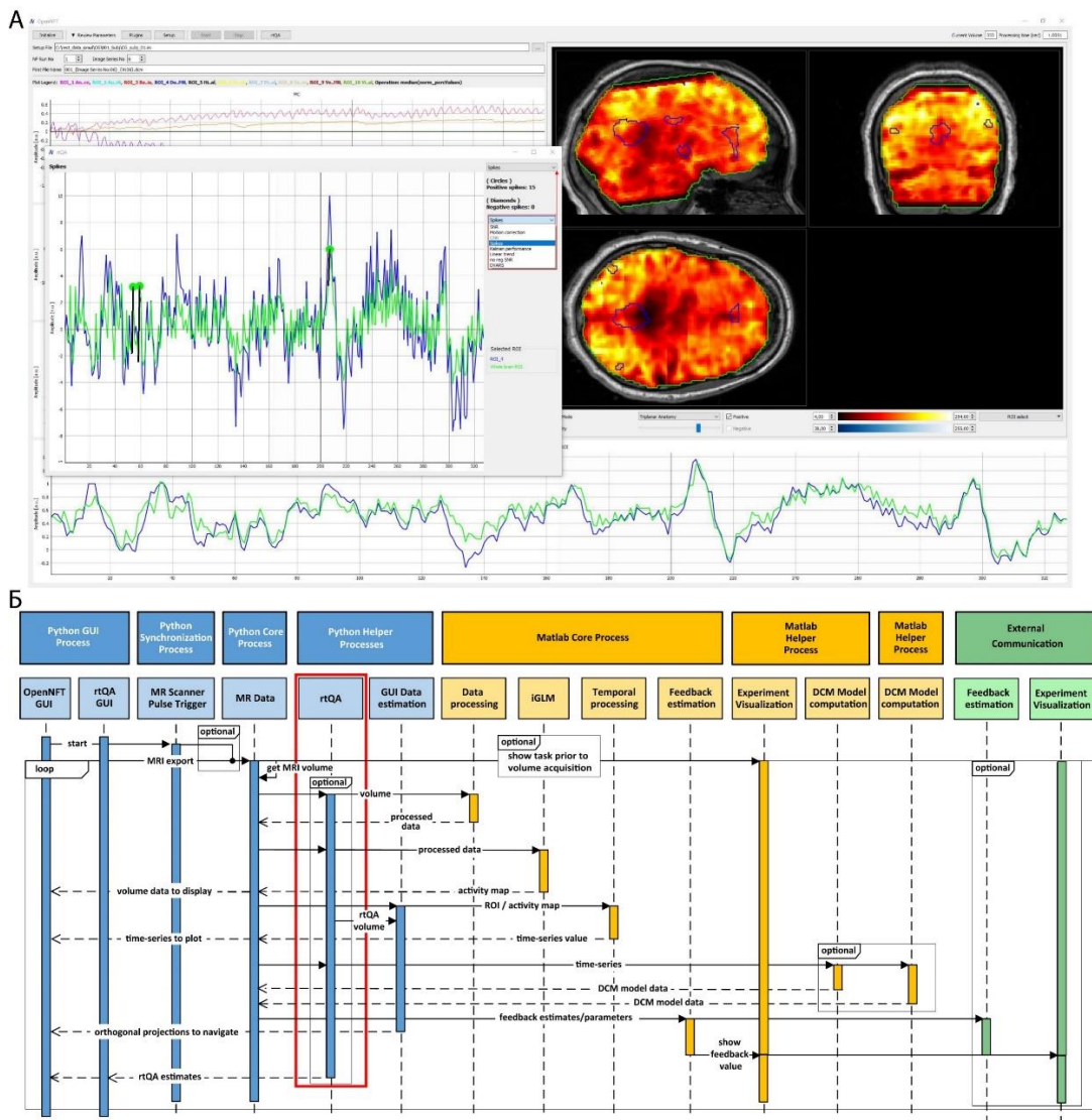
Рисунок 14 – Пример работы программного комплекса OpenNFT с включённым модулем контроля качества в реальном режиме времени (панель А). На скриншоте продемонстрирован вывод обнаруженных пиков в обрабатываемом сигнале. На панели Б продемонстрирована архитектура программного комплекса и место интеграции модуля контроля качества в общую архитектуру (красной рамкой выделено место интеграции модуля).
