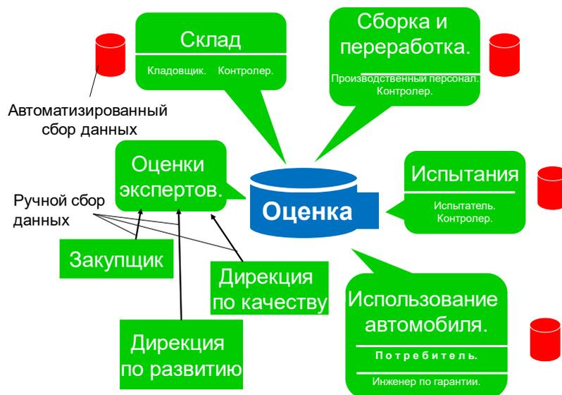
Рисунок 4.1 – Графическая интерпретация схемы сбора данных для организации работы самонастраивающейся целевой функции качества автосборочного предприятия
