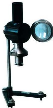
Рисунок 2.3 – Аппарат ЛВП-М для определения высоты некоптящего пламени
