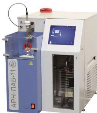
Рисунок 2.2 – Аппарат АРН-ЛАБ-11 для определения кривой дистилляции и фракционного состава многокомпонентного углеводородного топлива
