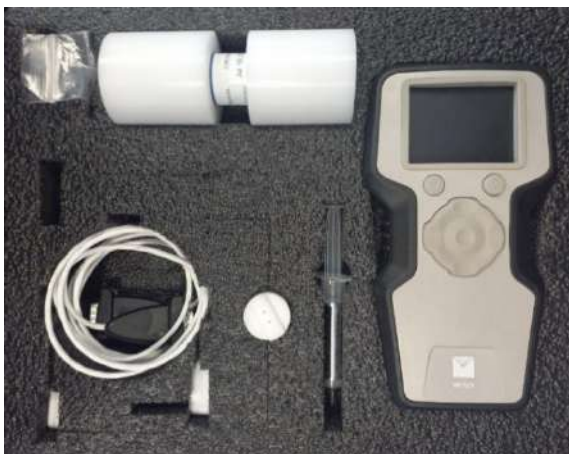
Рисунок 2.1 – Прибор TEMPOS для измерения теплопроводности и теплоемкости жидкости
