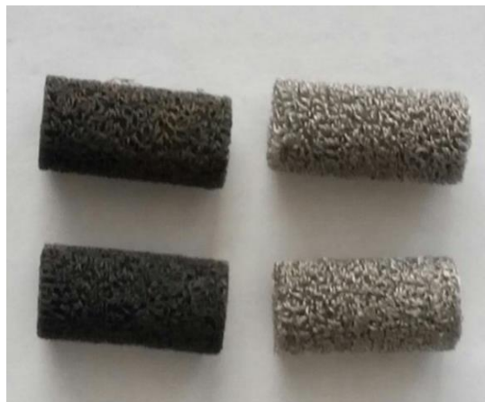
Рисунок 10 – Внешний вид оксидированного и не оксидированного блочного носителя из нихрома
