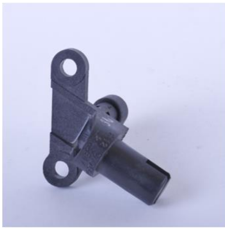
Рисунок 1.11 – Внешний вид и основные проблемы качества датчика фаз газораспределения
