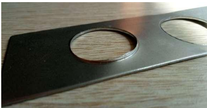
Рисунок 3.17 - Образование заусенцев при неравномерном межинструментальном зазоре
