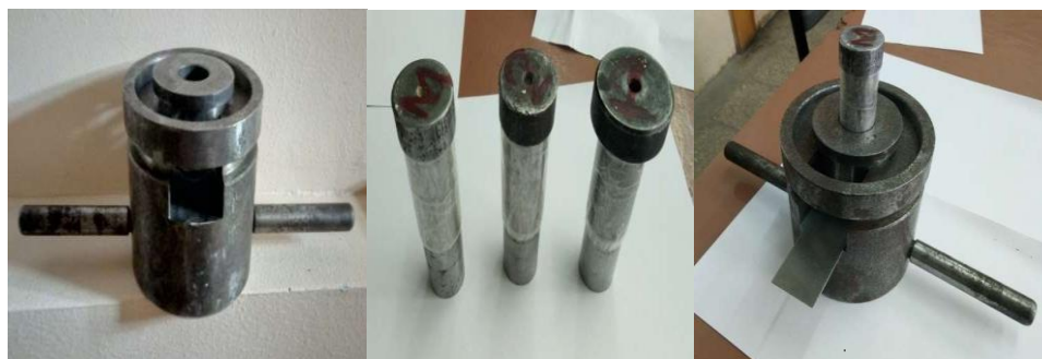
Рисунок 3.18 - Экспериментальная вырубная оснастка:
