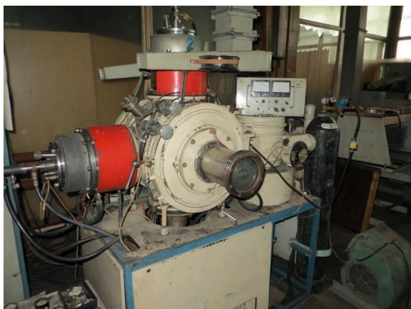
Рисунок 4.3 - Установка для нанесения износостойких покрытий «Булат-6»
