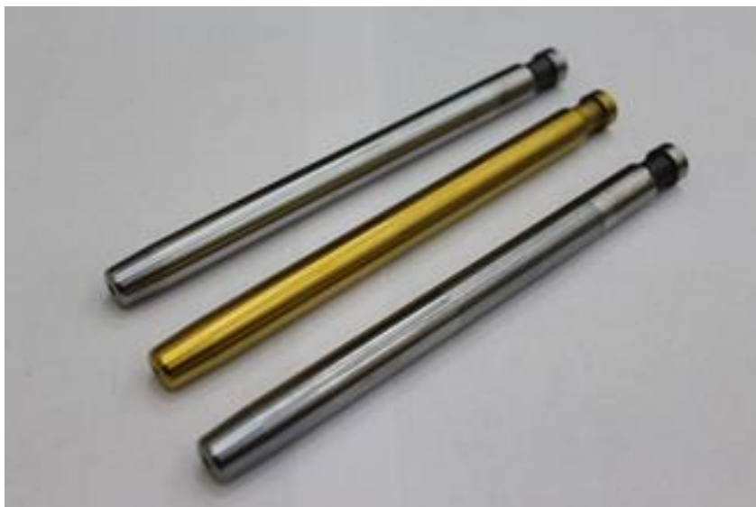
Рисунок 4.2 - Пуансоны для вытяжки без покрытия и с покрытием TiN
