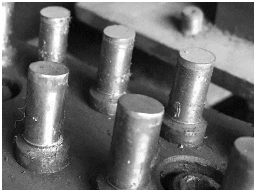
Рисунок 4.10 - Комплект изношенных пуансонов (после испытаний)
