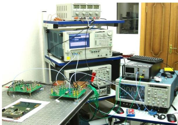
Рисунок 4.16 – Фотография испытательного стенда для исследования скоростных характеристик оптической шины передачи данных на печатной плате
