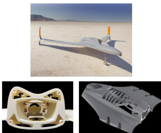
Рисунок 3 – БПЛА Aurora Flight Sciences и его корпусные детали, изготовленные с помощью FDM 3D-печати [12]
