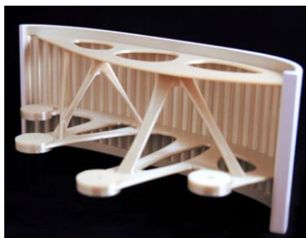
Рисунок 7 – Распорная панель, изготовленная с помощью FDM 3D-печати [15]
