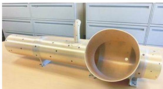
Рисунок 5 – Элемент системы кондиционирования воздуха усовершенствованной конструкции ракет-носителей Atlas V и Delta IV [12].
