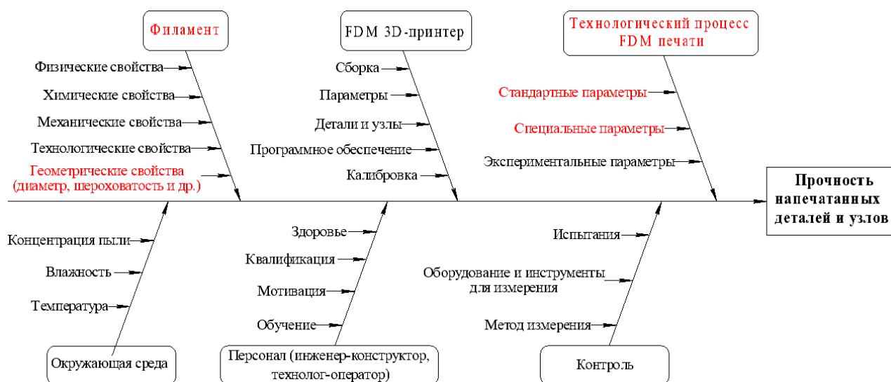
Рисунок 38 – Диаграмма Исикавы для FDM 3D-печати деталей и узлов
