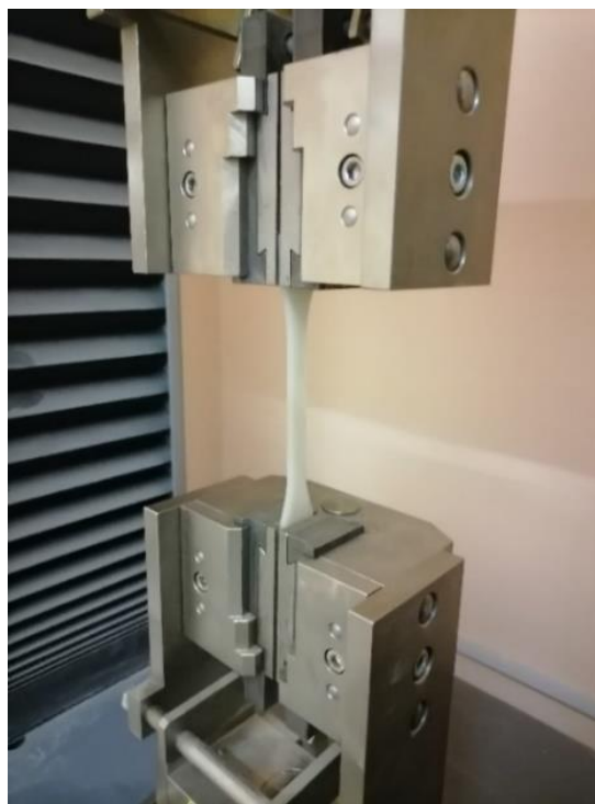
Рисунок 79 – Напечатанный образец в тисках универсальной испытательной машины фирмы ZwickRoell Z050
