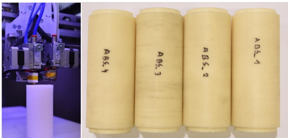
Рисунок 12 – Топливные зерна ракетного двигателя, изготовленные с помощью FDM 3D-печати [20]
