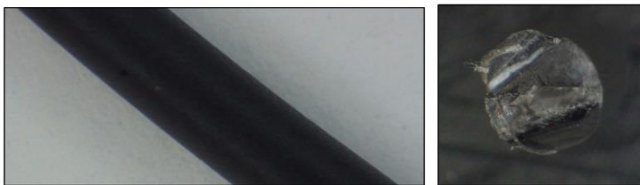
Рисунок 45 – Фотоизображение филамента ABS с цифрового микроскопа
