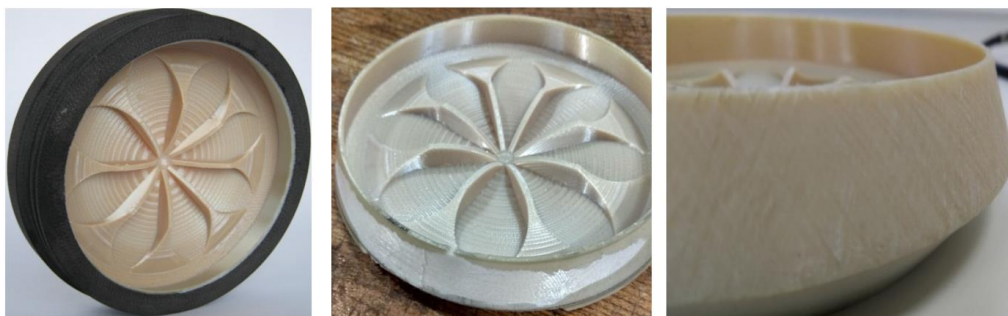
Рисунок 11 – Заглушка сопла «мембранного» типа, изготовленная с помощью FDM 3D-печати [19]
