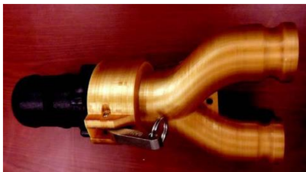
Рисунок 6 – Патрубок авиадвигателя, изготовленный с помощью FDM 3D-печати [12]
