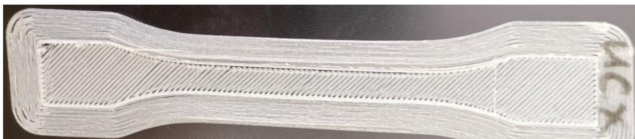
Рисунок 46 – Первый слой FDM печати образца с вариабельности диаметра прутка филамента: D_{\max} = 1,75 мм, D_{\min} = 1,61 мм
