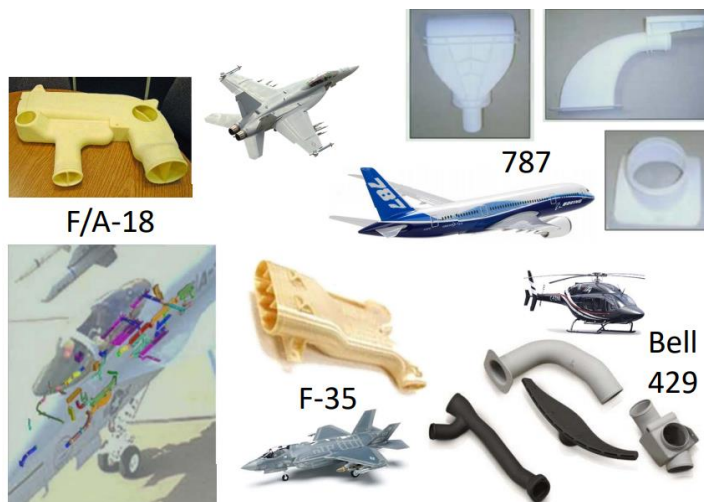
Рисунок 4 – Детали и узлы воздухопроводов, получаемые технологией FDM 3D-принтеров [13]
