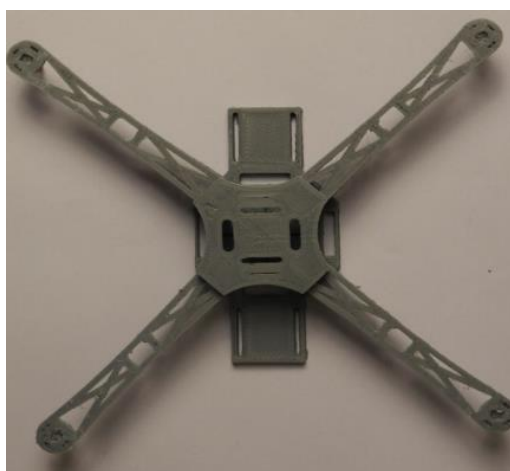
Рисунок 10 – Планер БПЛА мульти-роторного типа, изготовленный с помощью FDM 3D-печати [18]
