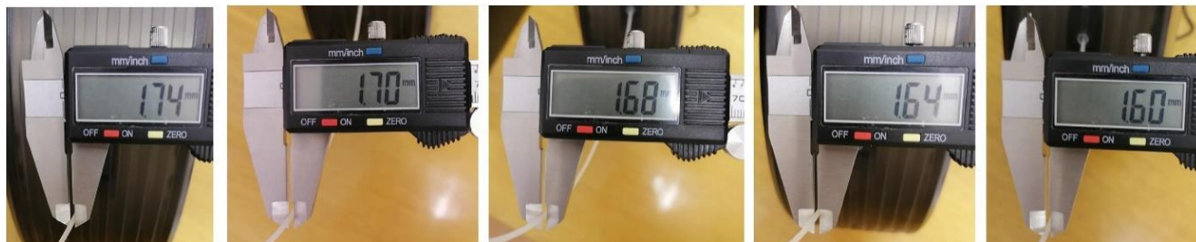
Рисунок 39 – Замер диаметра прутка специального филамента цифровым штангенциркулем
