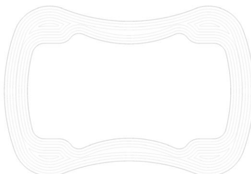
Рисунок 30 – Построение эквидистантных контуров в системе Симплекс [96]
