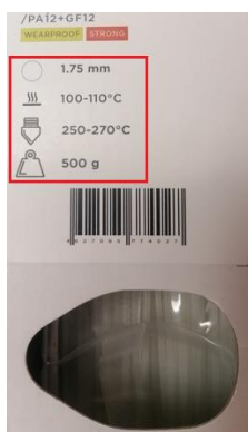
Рисунок 46 – Основные технологические режимы печати филамента
