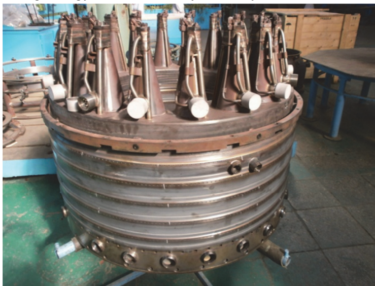
Рис. 1. Камера сгорания ГТУ SGT-600
