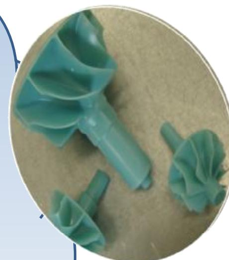
*ü Изготовление технологической оснастки для литья фасонных деталей из различных металлов и полимеров.*
