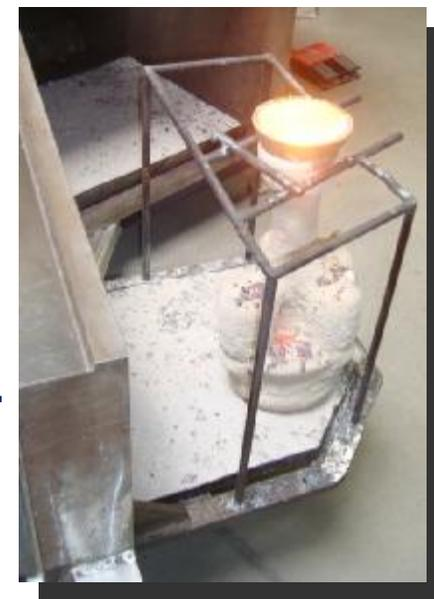
**Вакуумная машина с индукционным нагревом для литья конструкционных и нержавеющей сталей. Машина выполнена по схеме с опрокидывающимся (поворотным) тиглем объемом 3,5 л. Макс. температура заливки 1750°C.**
