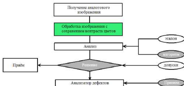
Рисунок 1 - Предлагаемый алгоритм нахождения дефектов с помощью АОI
