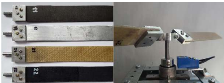
Рисунок 1 – Экспериментальные образцы модели лопасти, выполненные из различных материалов и механизм регулировки угла установки модели лопасти, соответственно
