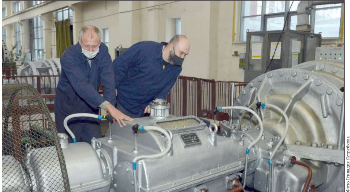
А. Н. Ждакаев (слева) и А. А. Никитенко проводят технический осмотр компрессора
