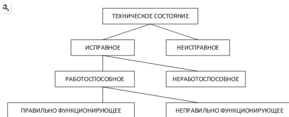
Рис. 2. Виды технических состояний
