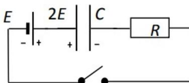
Электрическая цепь состоит из соединённых последовательно идеального источника напряжения с ЭДС  $E = 12 \text{ В}$ , резистора, разомкнутого ключа и заряженного до напряжения  $2E$  конденсатора (полярность указана на схеме). Ключ замыкают. Определите напряжение  $U$  на конденсаторе в тот момент, когда количество теплоты, выделившееся в резисторе, окажется в 3 раза меньше энергии, оставшейся в конденсаторе.
