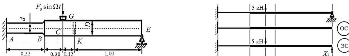
Обучающемуся предлагается рассчитать параметры циклов нагружения, определить опасные сечения, и определить коэффициенты запаса в каждом опасном сечении. Для наиболее опасного сечения строится схематизированная диаграмма предельных амплитуд цикла.
