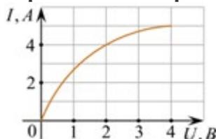
На графике показана зависимость силы тока  $I$ , текущего через электрическую лампу накаливания, от приложенного к ней напряжения  $U$ . Из приведённого ниже списка выберите все верные утверждения.
