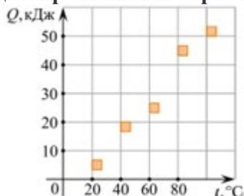
На графике представлены результаты измерения количества теплоты  $Q$ , затраченного на нагревание 1 кг некоторого вещества, при различных значениях температуры  $t$  этого вещества. Погрешность измерения количества теплоты  $\Delta Q = \pm 500$  Дж, температуры  $\Delta t = \pm 2$  К. Выберите утверждение, соответствующее результатам этих измерений.
