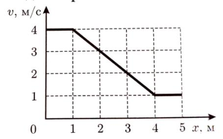
Тело движется по прямой. График зависимости его скорости  $v$  от координаты  $x$  приведен на рисунке. Найдите ускорение тела в точке с координатой  $x = 3$  м. Найдите также максимальное ускорение тела на отрезке от 0 до 5 м.
