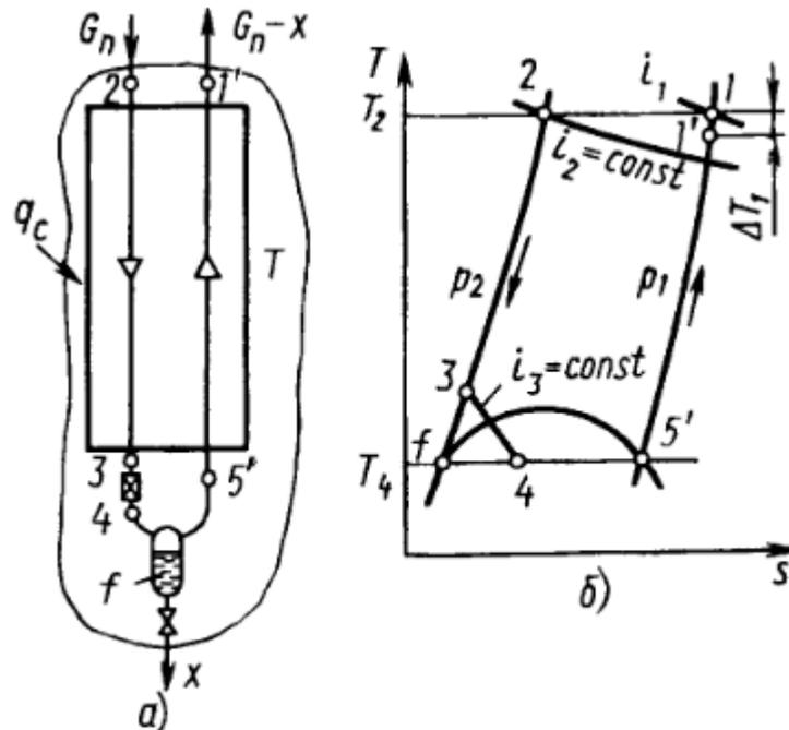
1. ожигительный цикл с охлаждением в ступени с дроселированием
