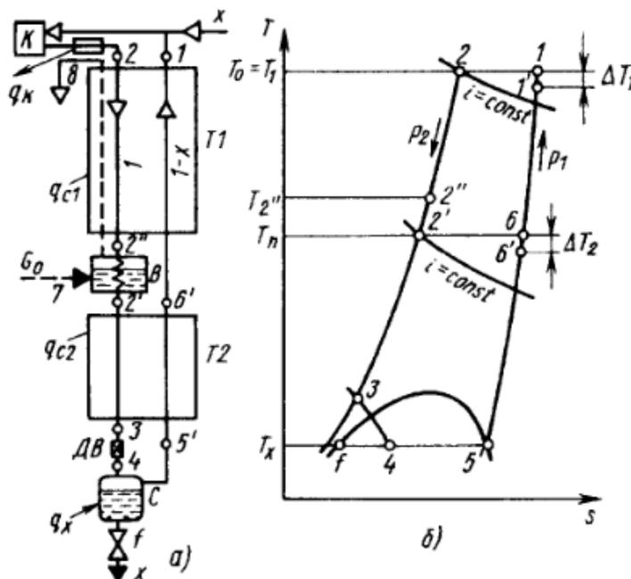
1. цикл с дросселированием и предварительным внешним охлаждением
