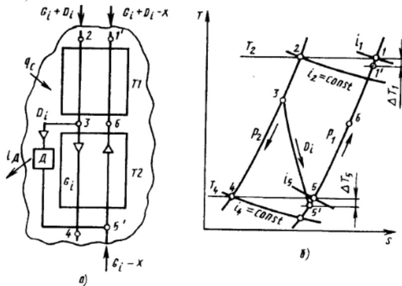
1. ожизительный цикл с охлаждением в ступени с расширением потока в детандере
