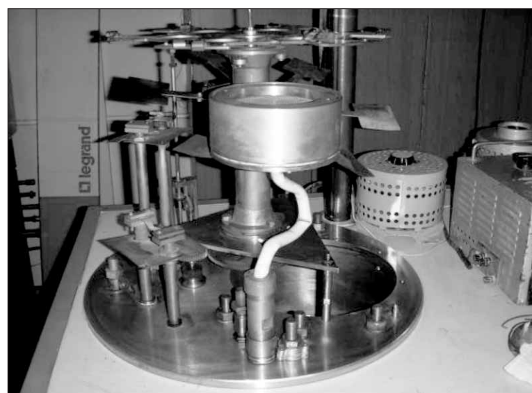
Источник направленных потоков низкотемпературной плазмы: ток разряда - 0...200 мА; ускоряющее напряжение - 0,3...6 кВ; равномерность распределения заряженных частиц по сечению плазменного потока - не менее 98%.
