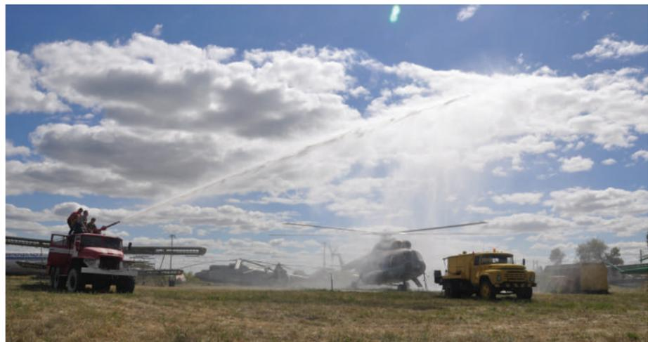
Работу систем вертолёта Ми-8 проводили в «условиях плохой погоды». «Ливень» обеспечил пожарный гидрант
