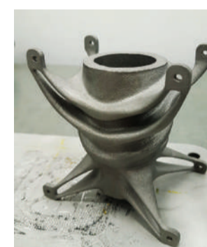
На орбиту отправился сверхкомпактный объектив, оснащенный одной дифракционной линзой, корпус которого выращен в лаборатории аддитивных технологий с помощью бионического дизайна
