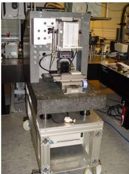
Рис.4 Общий вид установки трехмерного наноструктурирования на основе двухфотонной полимеризации 3D2S
