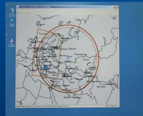
Зона покрытия пункта приема данных дистанционного зондирования СГАУ и трасса ИСЗ "Aqua"
