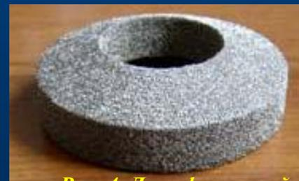
*Рис. 4. Демпфирующий элемент из материала МР*
