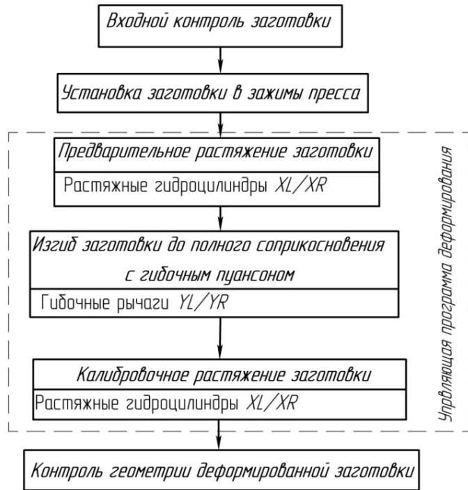
Рисунок – 1.4. Блок-схема технологии гибки с растяжением по схеме Р-И-Р
