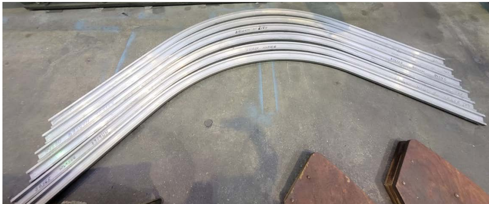
Рисунок 4.9 – Внешний вид изготовленных заготовок сегментов шпангоутов №9-№16 с применением адаптивного управления
