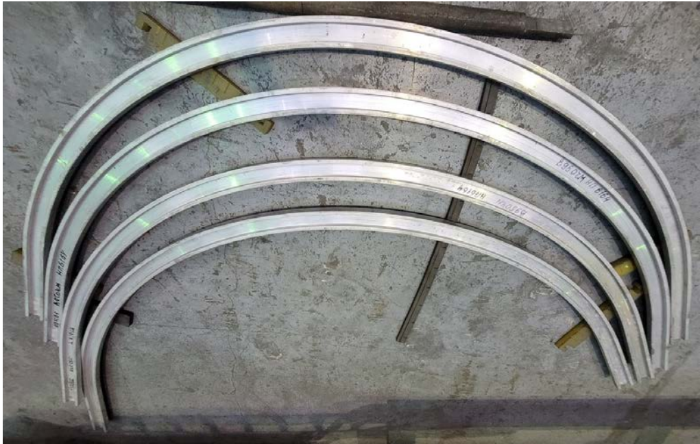
Рисунок 4.8 – Внешний вид изготовленных заготовок сегментов шпангоутов №1-№8 с применением адаптивного управления
