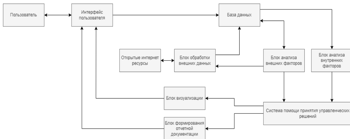
Рисунок 5.5 - Функциональная схема программной реализации системы поддержки принятия решений
