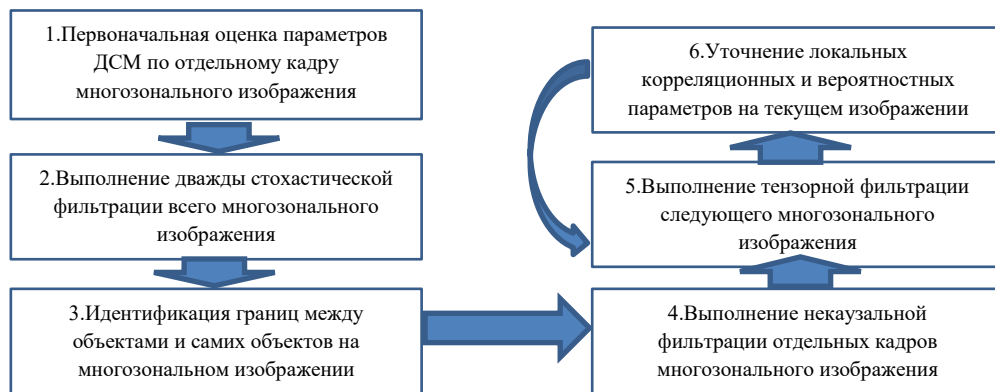
Рисунок 3.33 – Схема обработки последовательности многозональных изображений
