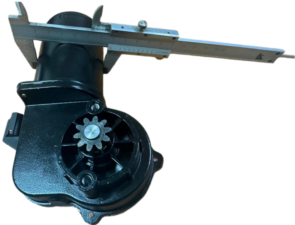
Рисунок 4.4 – Замер наружного диаметра корпуса двигателя
