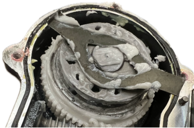
Рисунок 2.11 – Внешний вид перекаленной пружины электромоторедуктора служебной двери
