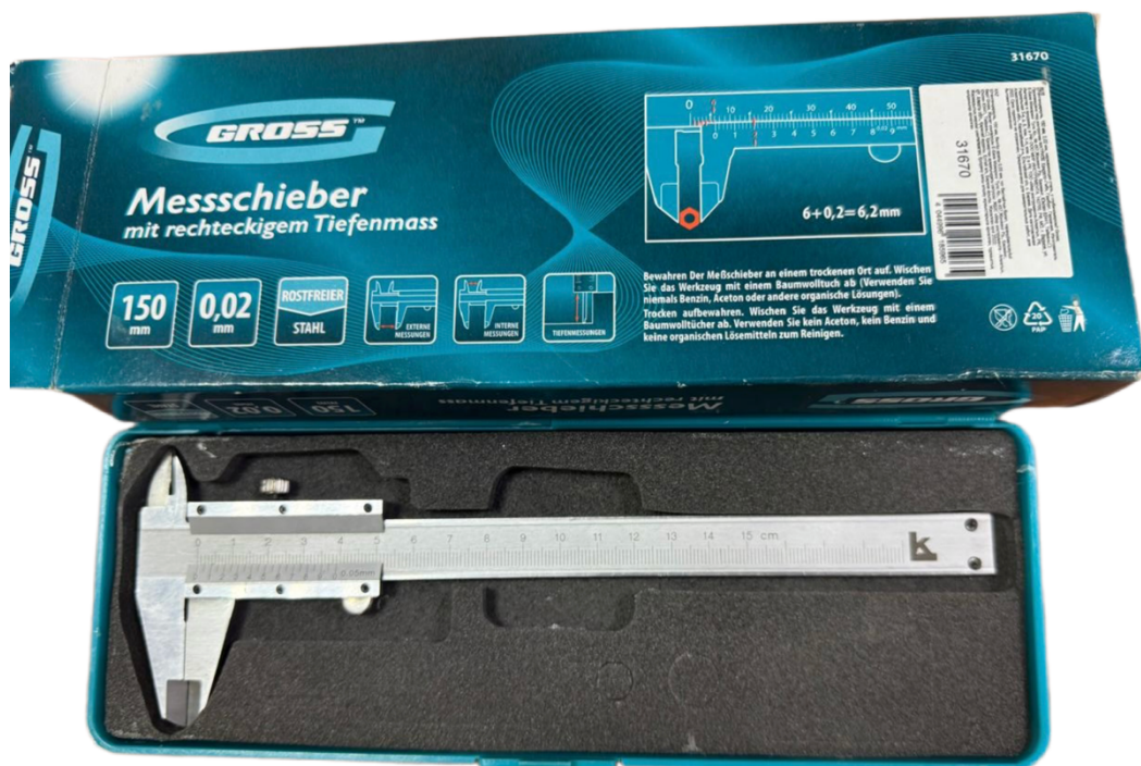
Рисунок 4.3 – Внешний вид штангенциркуля ШЦ–1
