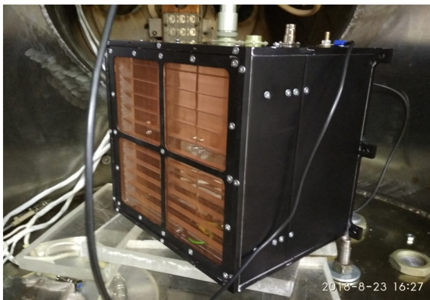
Рисунок 2.48 – Фотография научной аппаратуры в вакуумной камере ускорителя микрочастиц
