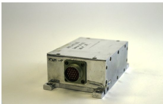
Рисунок 5.21 – Внешний вид магнитного датчика [200*]
