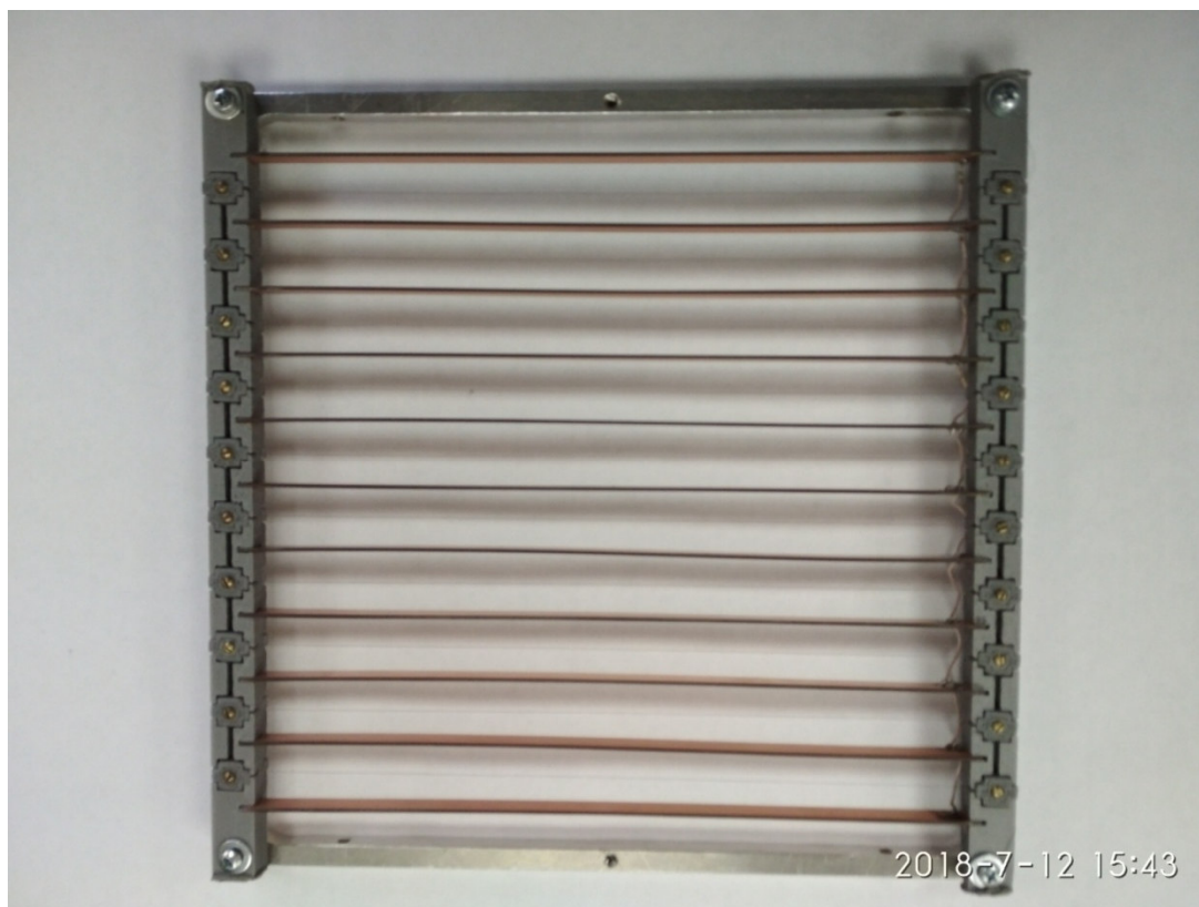
Рисунок 2.51 – Система электродов научной аппаратуры
