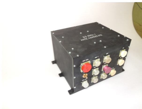
Рисунок 5.17– Внешний вид блока компенсации микроускорений (КМУ) [200*]
