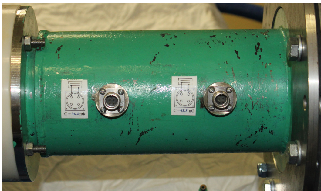
Рисунок 4.15 - Фотография корпуса участка ускорителя микрочастиц с двумя цилиндрами Фарадея
