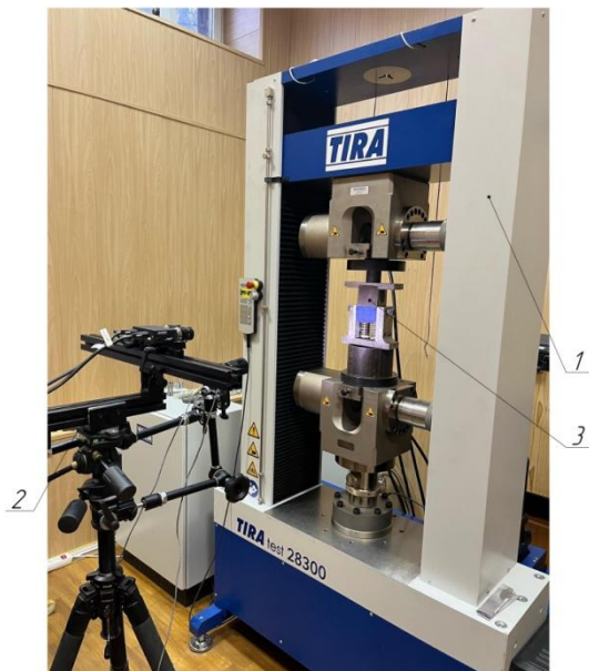
Рисунок 10 – Общий вид испытательного стенда: 1 – испытательная машина TIRAtest 28300; 2 – система бесконтактного измерения деформаций VIC-3D; 3 – штамповая оснастка
