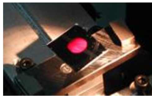
Рисунок 20 – (а) Вид установки для формирования субмикронных брэгговских решеток в полимерных волноводах. 1 – He-Cd лазер ( \lambda = 325 нм, P = 10 мВт), 2 – массив полимерных волноводов на кремниевой подложке, 3 – столик, 4 – система фокусировки. (б) Дифракция белого света от решетки с периодом d = 0.53 мкм, сформированной в массиве волноводов
