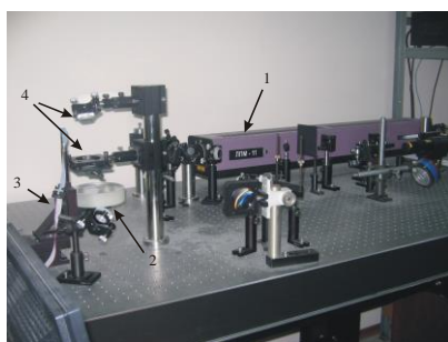
Рисунок 20 – (а) Вид установки для формирования субмикронных брэгговских решеток в полимерных волноводах. 1 – He-Cd лазер ( \lambda = 325 нм, P = 10 мВт), 2 – массив полимерных волноводов на кремниевой подложке, 3 – столик, 4 – система фокусировки. (б) Дифракция белого света от решетки с периодом d = 0.53 мкм, сформированной в массиве волноводов
