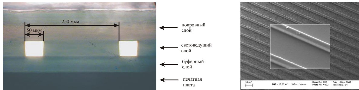
Рисунок 10 – Фотографии волноводов, изготовленных из фторсодержащих акриловых мономеров на печатной плате FR4 (а) и на кремниевой подложке (б) методом контактной УФ фотолитографии под действием актинического излучения с длиной волны 365 нм
