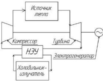
Рисунок 3 – Схема газотурбинной ЭУ космического ЛА
