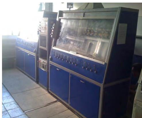
Стенд для испытания топливных трубок на герметичность
