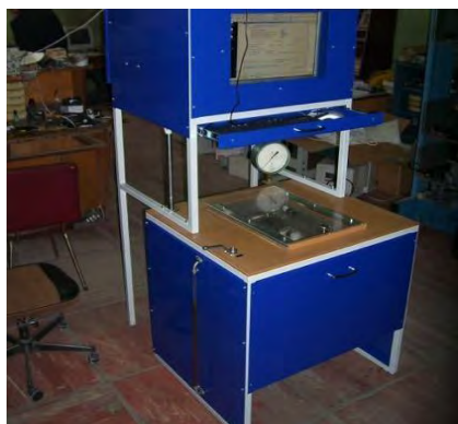
Стенд для проверки качества автомобильных топливных фильтров
