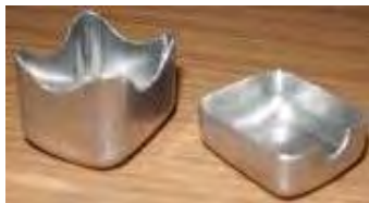
Гибридное воздействие: вытяжка + обрезка припуска
