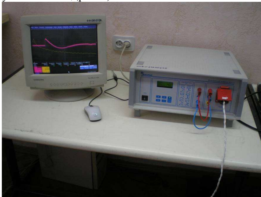
Рис. 1. Генератор ИГМ 4.1 и форма импульсной помехи (на мониторе)
