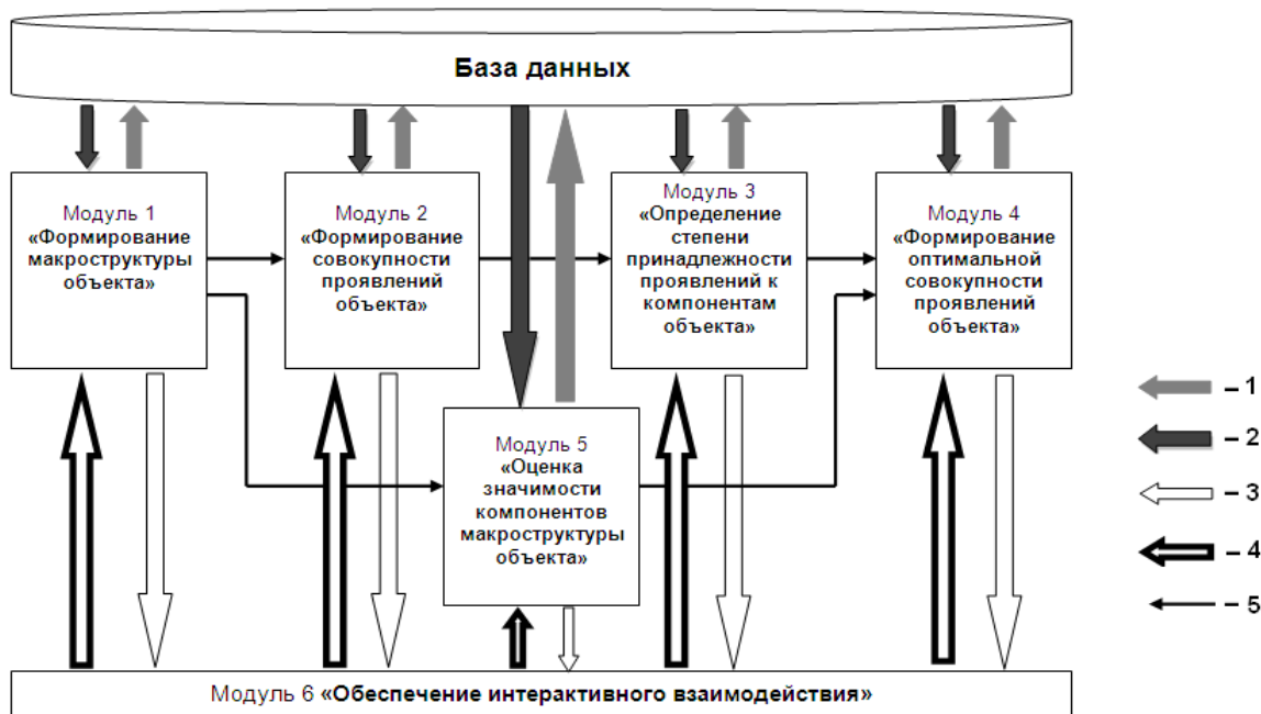
Рис. 1. Обобщенная архитектура программного комплекса «Model OSR». Цифрами обозначены информационные потоки, обеспечивающие: 1 – пополнение и корректировку базы данных; 2 – реализацию процедур модуля; 3 – интерактивность программы; 4 – интерактивные взаимодействия экспертов с программой; 5 – внутрисистемные информационные потребности.
