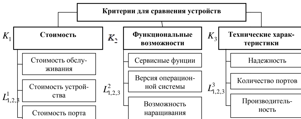
Рис.1. Критерии при выборе сетевого оборудования
