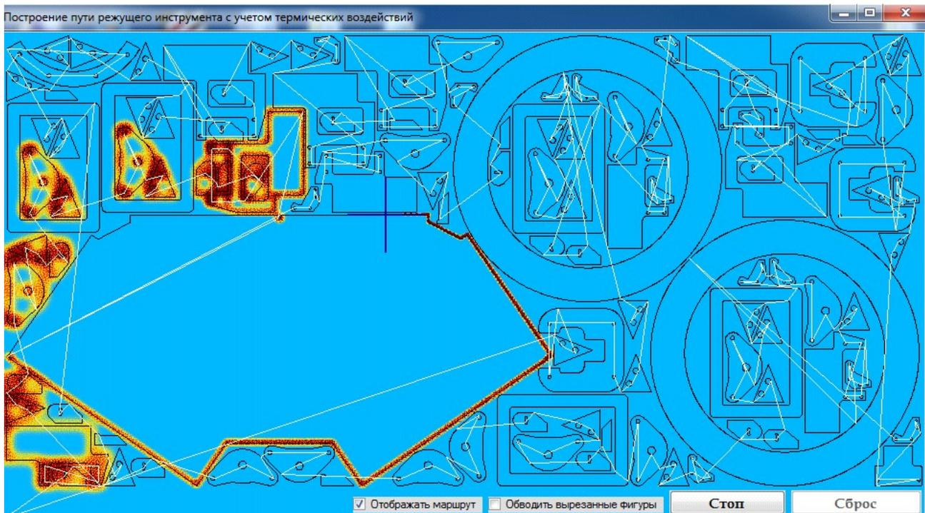
Рис. 3. Карта раскроя, путь режущего инструмента и  $T$  точек листа
