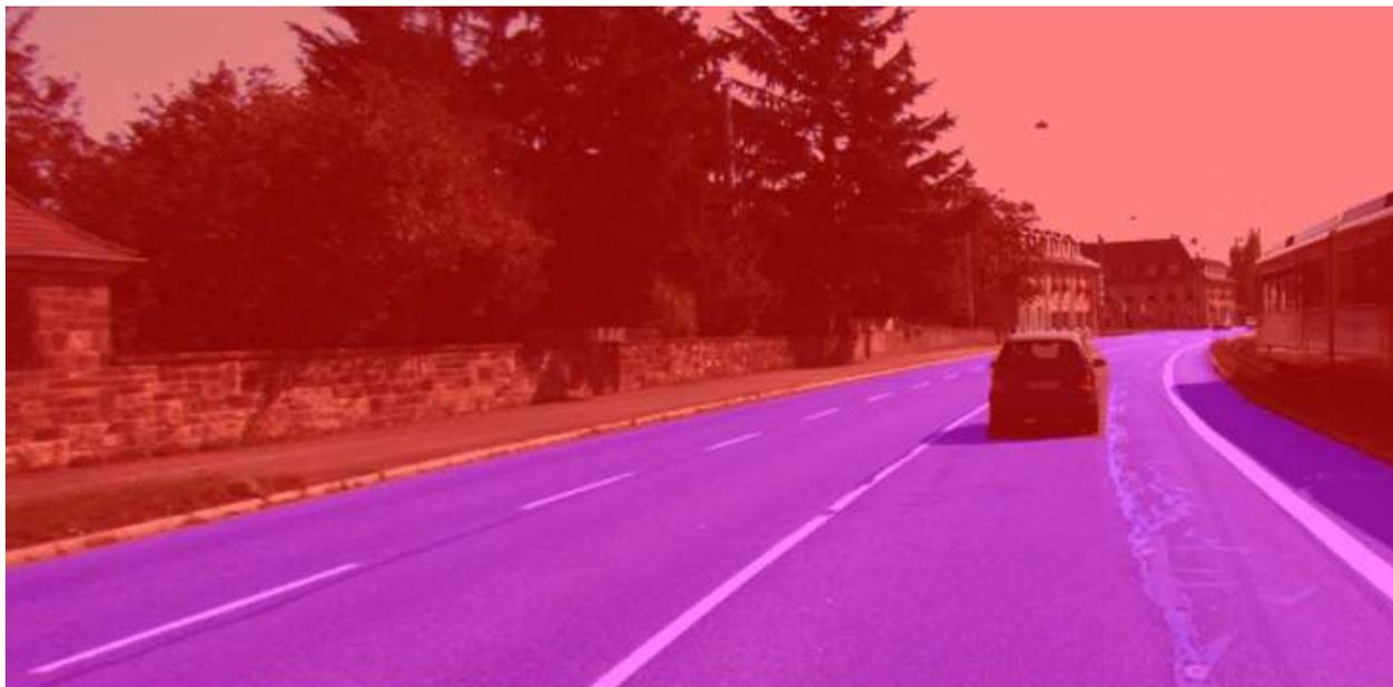
Рис. 2. Сегментация кадра видеозаписи на два класса
