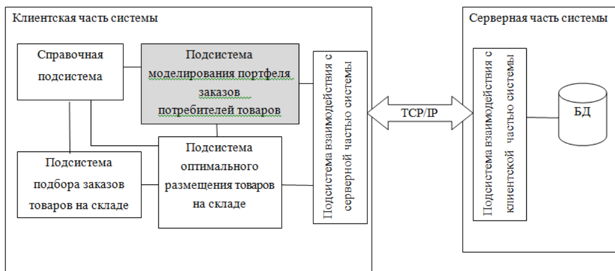
Рис. 1. Структурная схема системы моделирования работы складского комплекса
