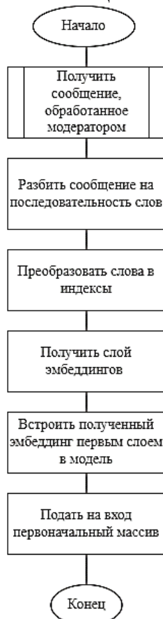
Рис. 1. Алгоритм добавления Embedding-слоя в нейронную сеть
