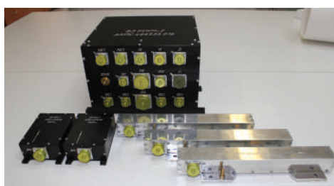
KSKM-2 измеряет магнитное поле
